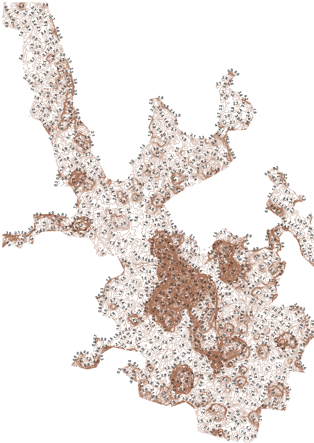
Curve di livello dal modello digitale 3D del terreno con delta a 0,30 cm.
